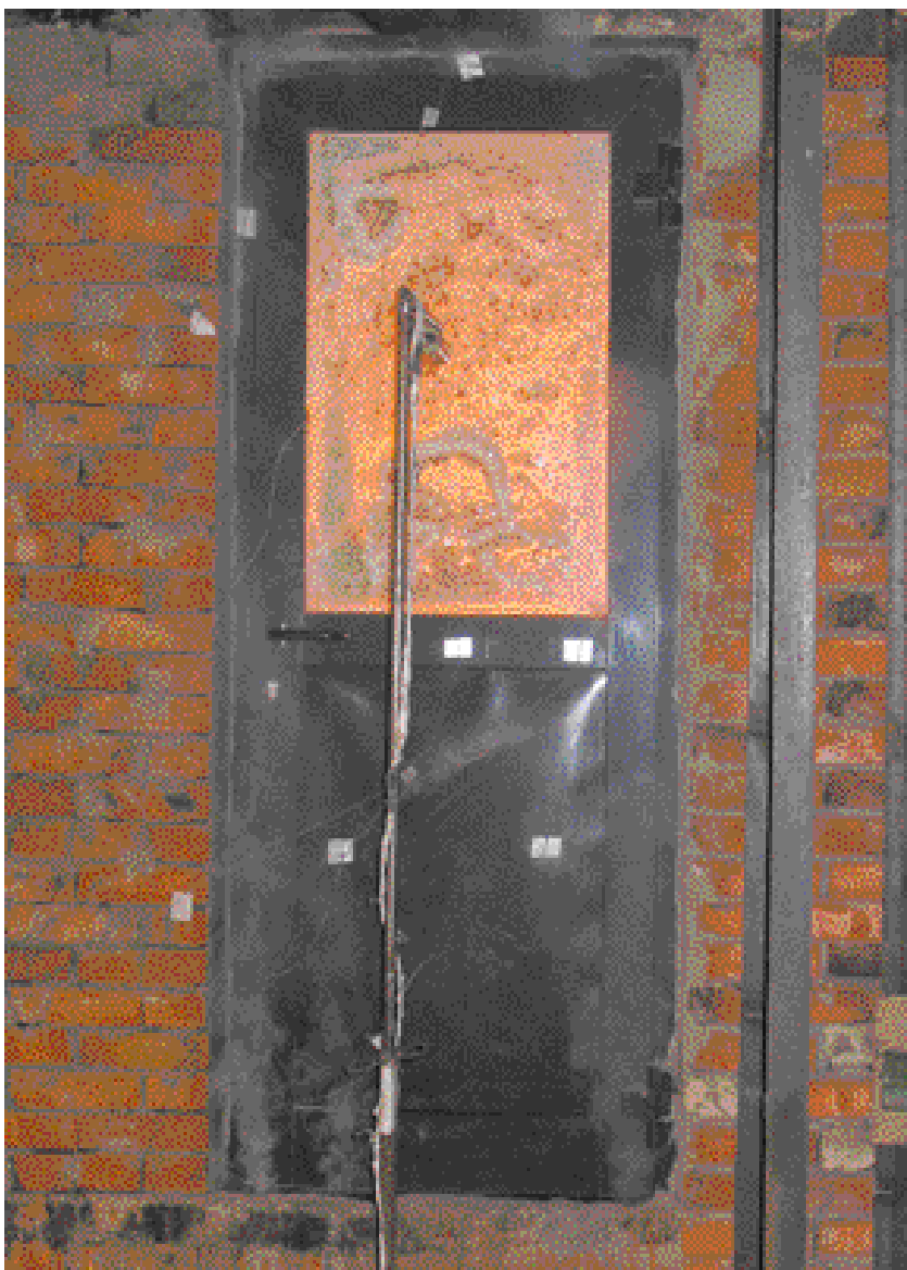
На сертификационных испытаниях противопожарных дверей Schueco FireStop II
